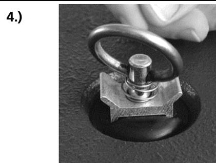
Lassen Sie die Arretierhilfe los, wenn sich die Zurröse in der Mitte des Flugpunktes befindet. Achten Sie darauf, dass die Arretierhilfe einrastet.
